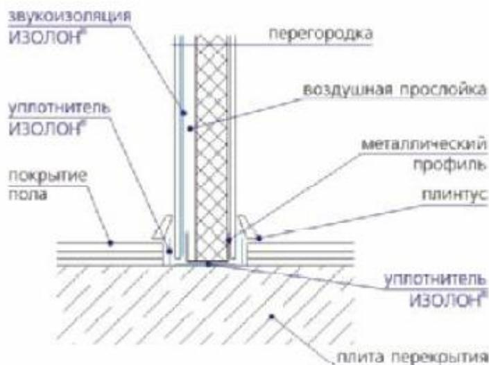
**ДОПОЛНИТЕЛЬНАЯ ЗВУКОИЗОЛЯЦИЯ ПЕРЕГОРОДОК:**
