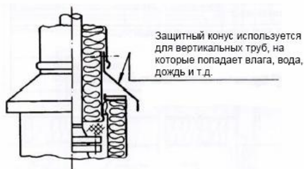
Рис. 176. Защитный конус для вертикальных участков трубопроводов
