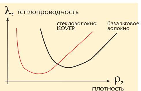
Зависимость между теплопроводностью и плотностью минераловатных утеплителей из стекловолокна ISOVER и из базальтового волокна.
